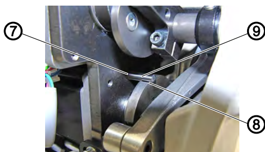
Rys. 21: Ustawienie mechanicznej regulacji ściegu (2)
