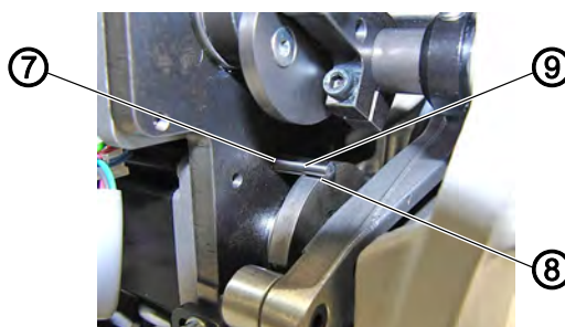
Fig. 21: Regolazione dello spostamento meccanico del punto (2)
