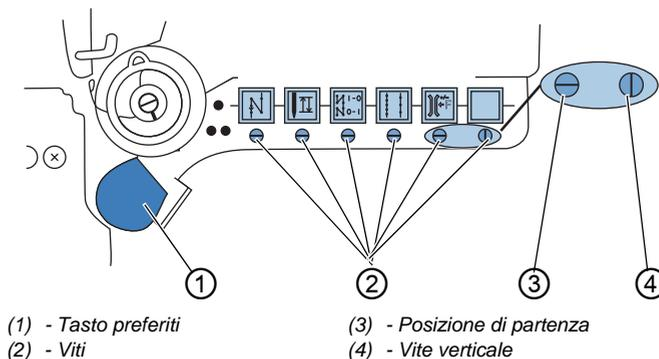
La funzione viene assegnata mettendo in posizione verticale la vite (2) ubicata sotto il tasto. È possibile assegnare al tasto preferiti (1) soltanto una funzione per volta. Perciò è consentito posizionare verticalmente (4) soltanto una delle viti (2).
