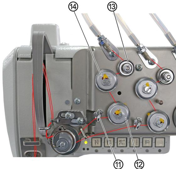
(11) - Guide-fil (fil d'aiguille de gauche) (13) - Prétendeur (fil d'aiguille de gauche)
