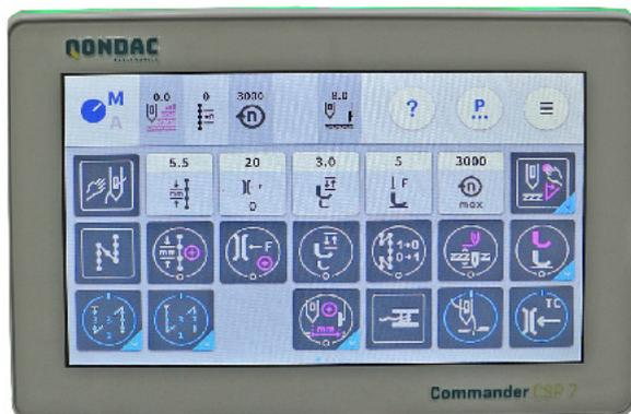
Tous les réglages du logiciel de la machine se font via le panneau de commande Commander Basic/Pro.
