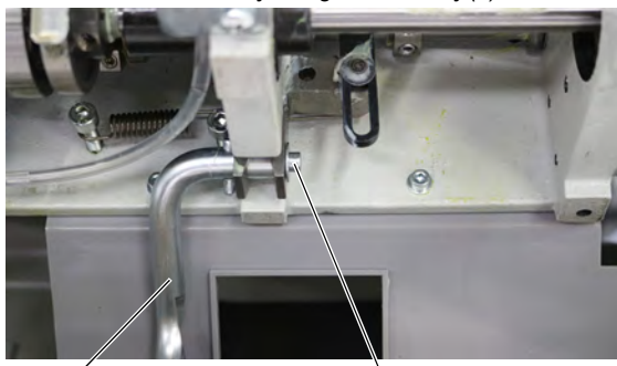
Rys. 63: Montaż mechanicznej dźwigni kolanowej (2)
