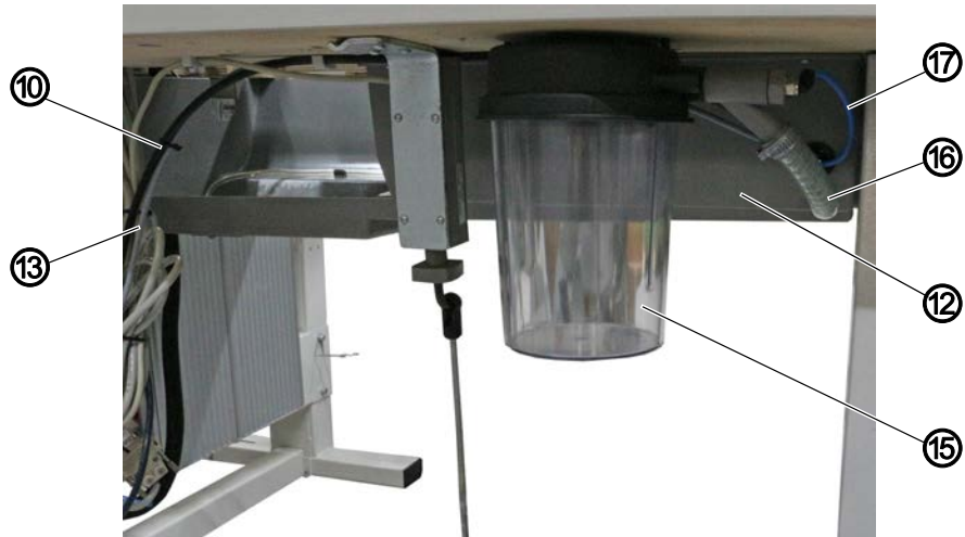
Abb. 12: NSB in die Maschine einbauen (7)
