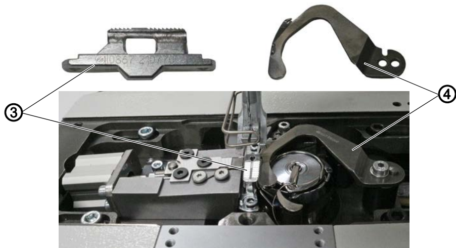
Abb. 8: NSB in die Maschine einbauen (3)
