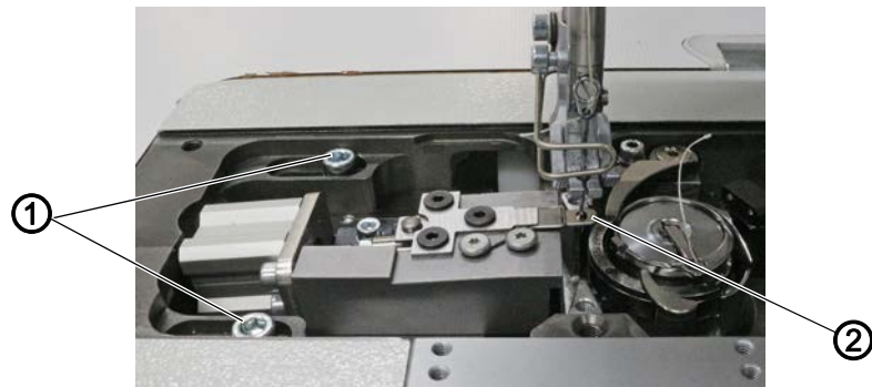
Abb. 7: NSB in die Maschine einbauen (2)
