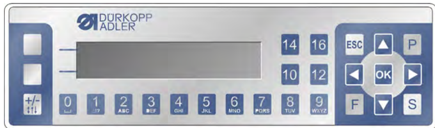
Abb. 20: Bei DAC comfort-Steuerung (2)
