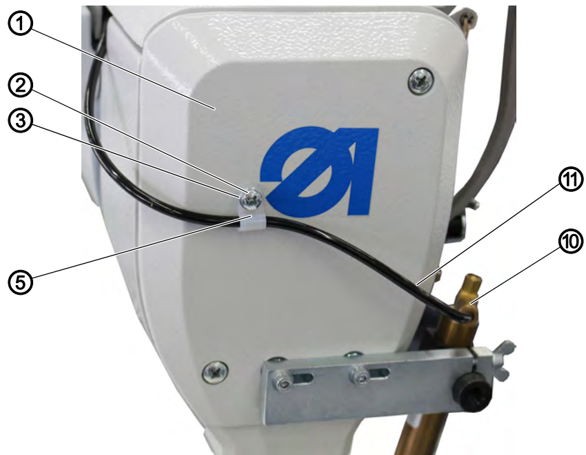
Abb. 10: Pneumatische Nahtmittenführung montieren (3)
