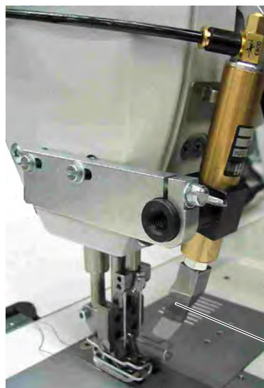
Abb. 12: Pneumatische Nahtmittenführung montieren (4)
