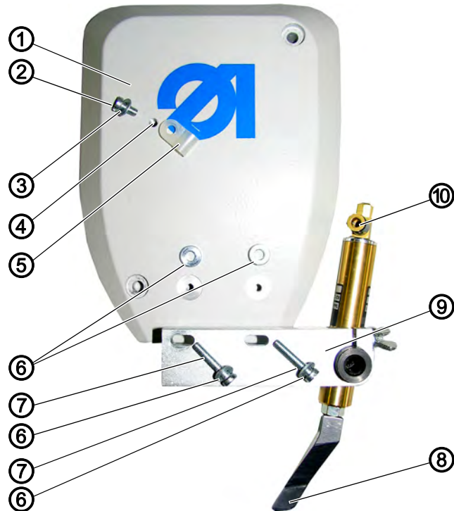
Abb. 8: Pneumatische Nahtmittenföhrung montieren (1)
