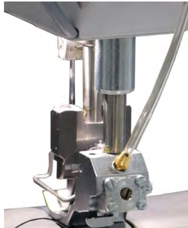
Abb. 11: Pneumatische Nahtmittenführung montieren (4)
