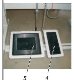
Wenn Sie das Untergestell MG53 002521 verwenden, schrauben Sie das mitgelieferte Pedal 4 mit den zwei Schrauben, zwei Scheiben und den zwei 6kt. Muttern an das Langloch neben das Antriebspedal 5.
