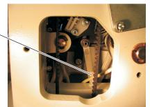
Kabel **4** (Verbindungsleitung zur Ventil-Leiterplatte) in der Ventil-Leiterplatte **5** Steckverbindung X24 anschliessen.
