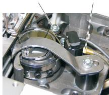
Position der Lichtschranke so einstellen, daß deren Lichtstrahl durch den Schlitz der Spulenkapsel auf die Reflexionsfläche der Spule und wieder zurück zur Lichtschranke gelangen kann.
