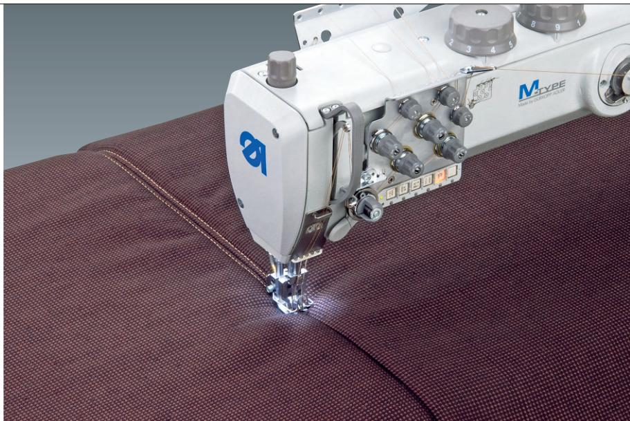
**867-290342-70-M** CLASSIC Goldline mit asymmetrischer Nächeinrichtung E751/10 und Nähapparat N027 für Kappnähte an Markisenbahnen / Zeltbahnen
