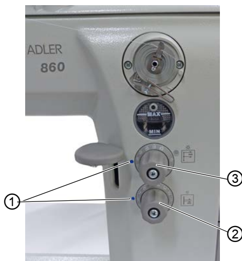
图 45: 设定线迹长度
