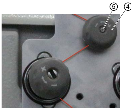
图 29: 设置针线张力 (2)
