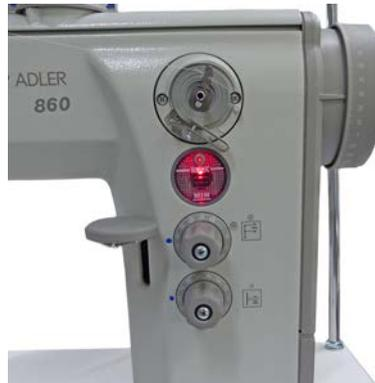
2. Si le niveau d'huile est inférieur au repère minimum (1) : ajouter de l'huile par l'orifice de remplissage (3) sans dépasser le repère de niveau maximum (2).
