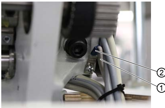
Fig. 85: Establishing equipotential bonding
