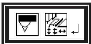
La fotocellula 1 controlla se il materiale da cucire è presente. Se sotto la fotocellula il materiale da cucire non è presente sul "Display" appare l'indicazione riportata qui a lato.
