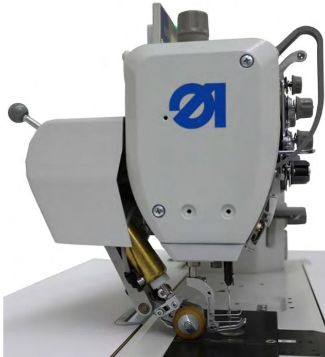
在缝纫压脚抬起和缝制加固缝过程中，输送滚轮自动抬起。
