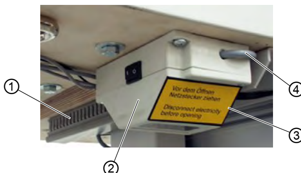
Fig. 42: Montaje y conexión del transformador de la iluminación del área de costura (1)
