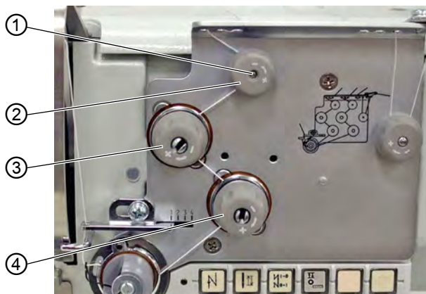
Fig. 10: Ajuste de la tensión del hilo de la aguja
