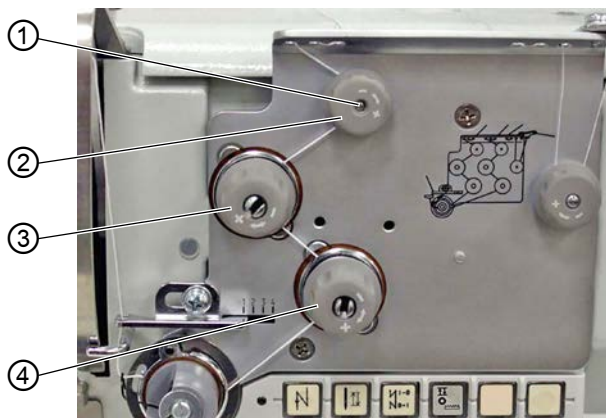
Obr. 10: Nastavení napnutí horní nitě
