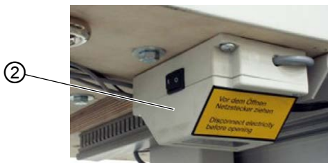
Obr. 45: Připojení osvětlení šicího stroje k jeho transformátoru (2)
