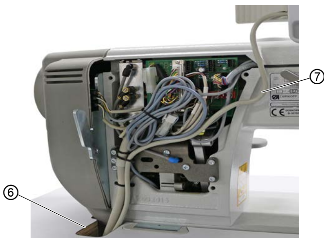
Obr. 35: Montáž ovládacího panelu (2)
