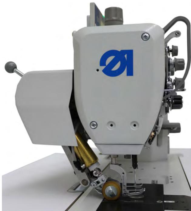
Die Transportwalze wird beim Nähfuß-Lüften und bei der Nahtverriegelung automatisch angehoben.
