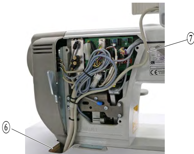
Rys. 35: Montaż panelu sterowania (2)
