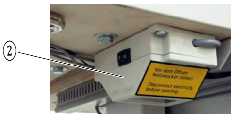
Rys. 45: Podłączanie lampki szycia do transformatora oświetlenia szycia (2)
