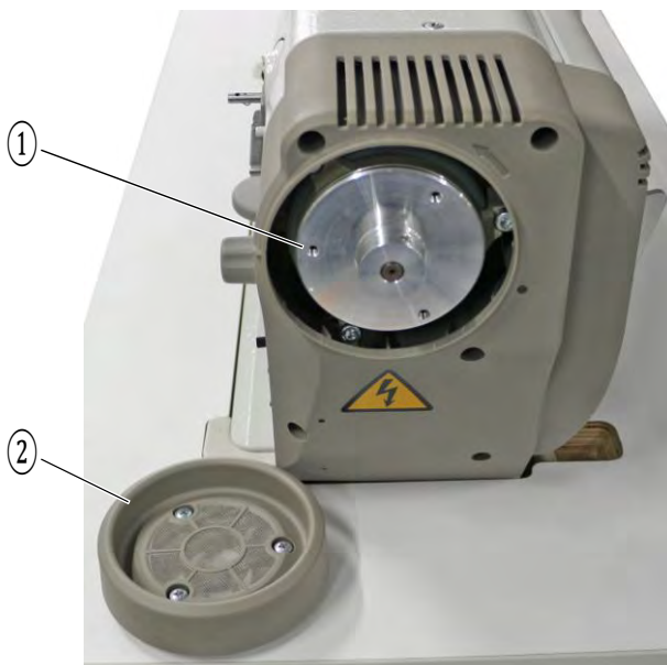
Rys. 23: Czyszczenie napędu bezpośredniego
