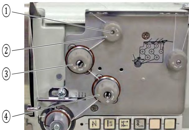
Rys. 10: Regulacja naprężenia nici igłowej
