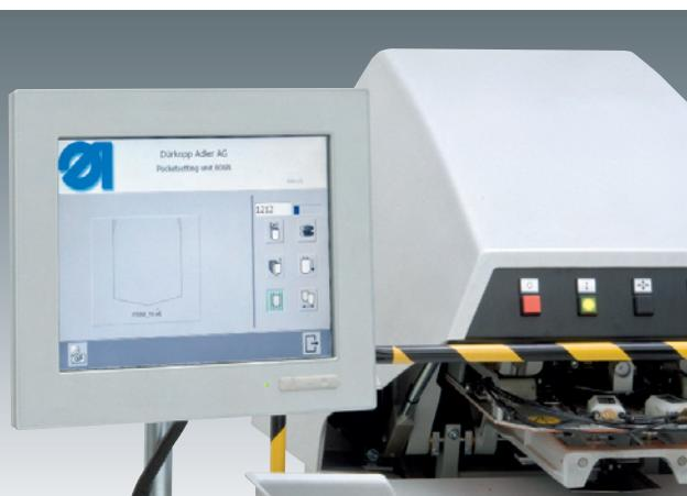
**Touch-Panel-PC:** mit Windows® Oberfläche mit integrierter Programmversion von „DACAD“ zum Erstellen und Modifizieren von Taschenprogrammen.
