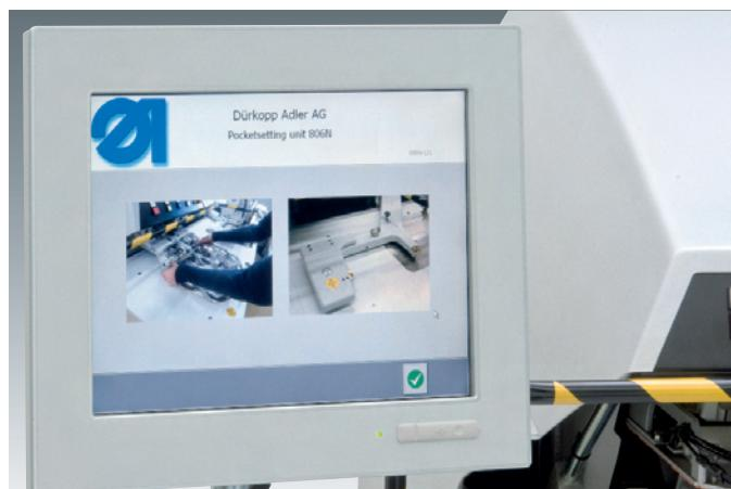
**Touch-Panel-PC:** für Störungsdiagnose, Service- und Hilfe-funktionen, wie z. B. eine Anleitung zum Formenwechsel für die Bedienperson.
