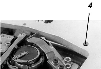
Der Schlingenhub ist der Weg der Nadelstange vom unteren Totpunkt bis zu dem Punkt, an dem die Greiferspitze auf Nadelmitte steht.
