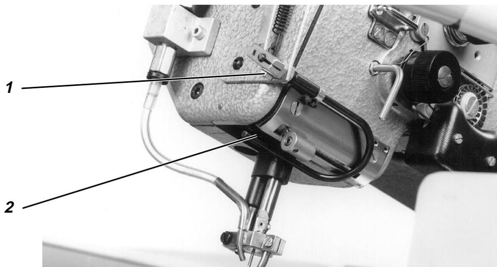
Während des Abschneidevorgangs wird der Fadenvorzieher 2 nach der Schlingenaufnahme vorgeschwenkt und während der 2. Bewegungsphase des Fadenziehmessers wieder zurückgeschwenkt.
