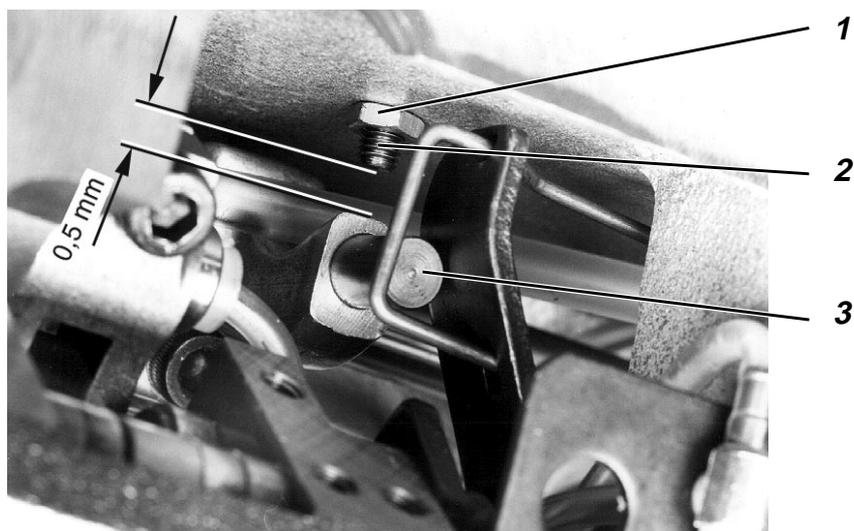
El tornillo de tope 2 limita el levantamiento cuando la palanca de rodilla ha sido presionada del todo hacia la derecha. Con ello se impide una colisión entre los prensatelas y la barra de la aguja.
