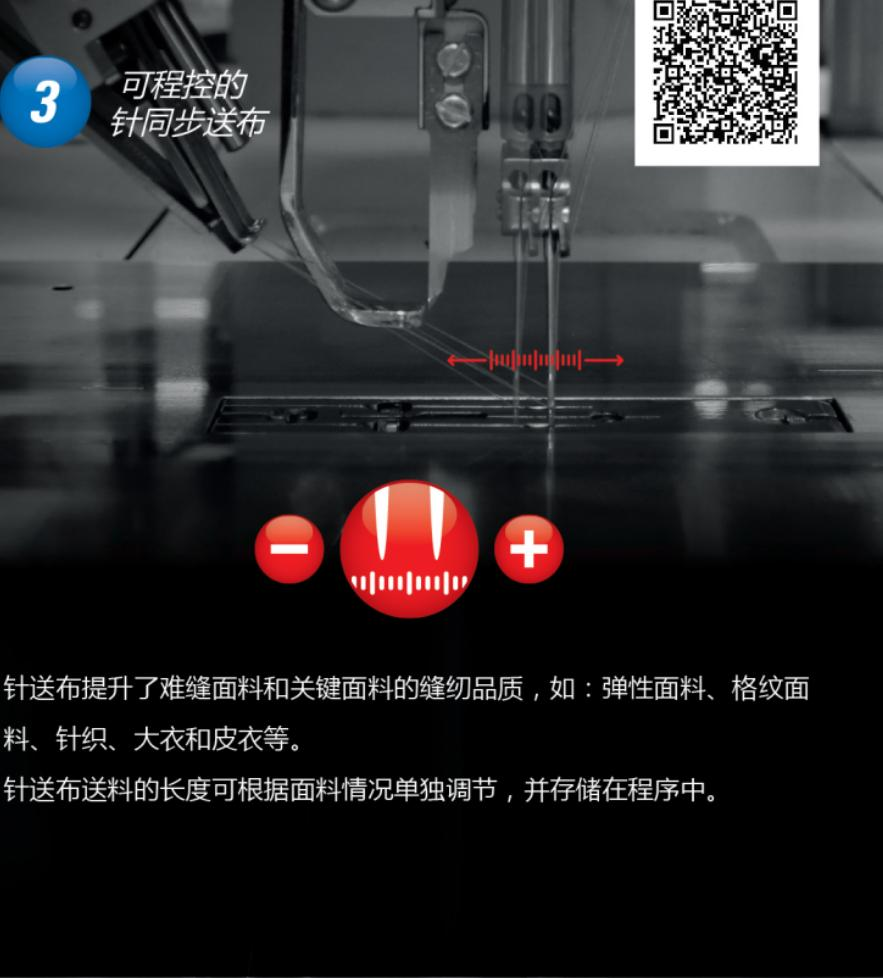
针送布提升了难缝面料和关键面料的缝纫品质，如：弹性面料、格纹面料、针织、大衣和皮衣等。
