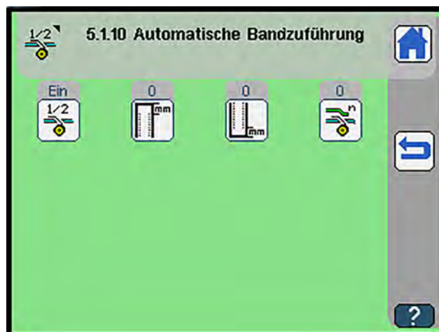
Abb. 13: Bandzuführung in der Software einrichten (2)
