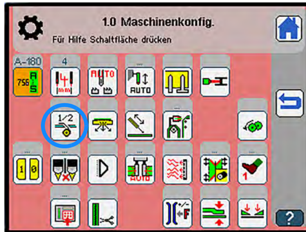
Abb. 12: Bandzuführung in der Software einrichten (1)
