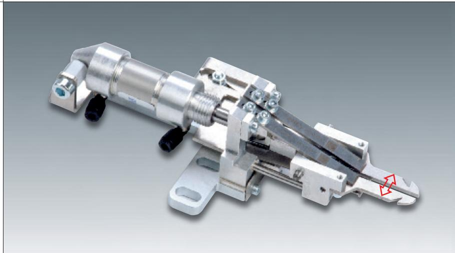
**Die Schneideeinrichtung** für Nadelfäden ist schnell und stufenlos verstellbar. Oberfadenfänger für Nadelabstände von 6 bis 22 mm sind standardmäßig enthalten. Für Nadelabstände von 22 bis 30 mm ist ein weiterer Oberfadenfänger optional erhältlich (0755 350554).
