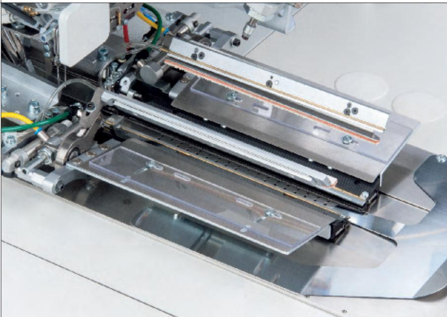
**Technisches Highlight – die Transportklammer K35** verbessert die Nahtqualität durch ihre einfache und flexible Justagemöglichkeit für eine perfekte Anpassung an die Anwendung. Sie ist für zwei unterschiedliche Nahtlängen erhältlich: max. 200 mm (0755 411104); max. 240 mm (0755 411204)
