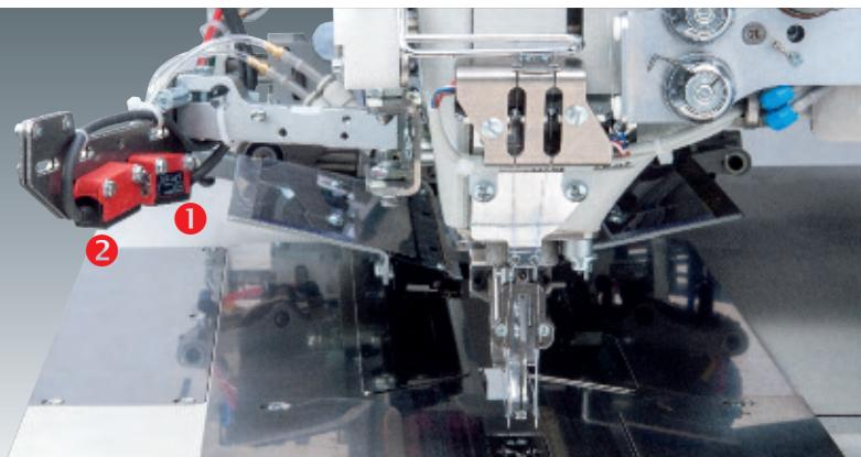
**Max. Taschenlängen** je nach Einrich-tung von 20 – 240 mm realisierbar. Bei Taschen mit Beilegteilen z. B. Patten, Besetzen oder Taschenbeuteln, ist eine max. Taschenlänge bis 220 mm möglich.
