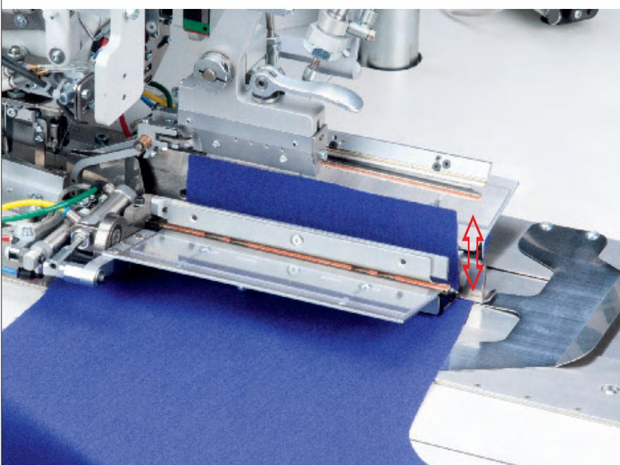
**Faltstempel optimiert für überbreite Paspelstreifen** für Hosentaschen mit extra breiten Paspelstreifen bis 60 mm links. Die integrierte Blasvorrichtung (Option) dient zum Aufrichten der extra breiten Paspelstreifen.
