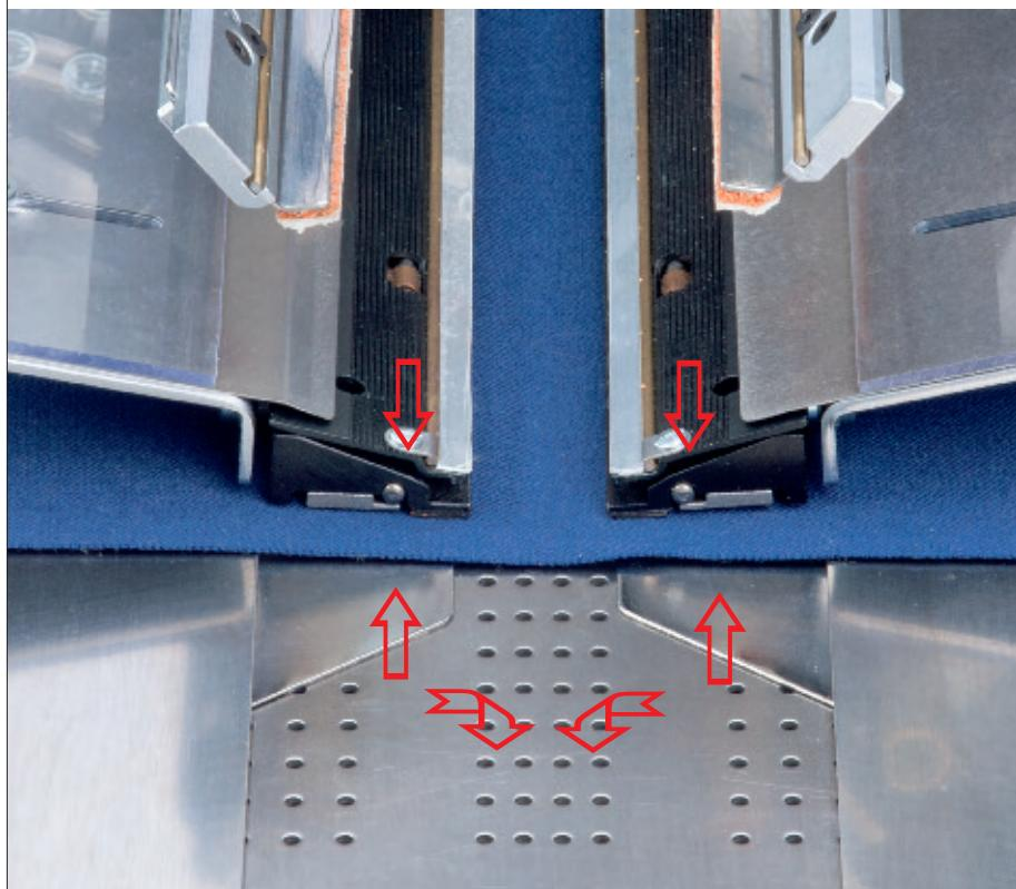
**Unterlegbleche mit einteiligem Gleitblech** (0755 590654 – verstellbar für mehrere Nadelabstände) und **Vakuum-Absaugung**
