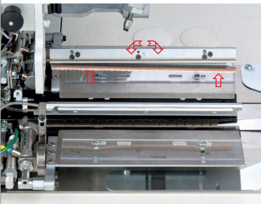
**Die Klammerleisten** sind sowohl flexibel als auch mit Vorspannung einstellbar. Dies unterstützt den Ausgleich von unterschiedlichen Materialstärken. Zudem verteilen die Klammerleisten gleichmäßig Druck auf die Patten. Zum einfacheren Einlegen der Paspel werden die Pattenklemmen weiter geöffnet. Die Gummierung an den Pattenklemmen verhindert unnötige Abdrücke im Material und gibt besseren Halt.
