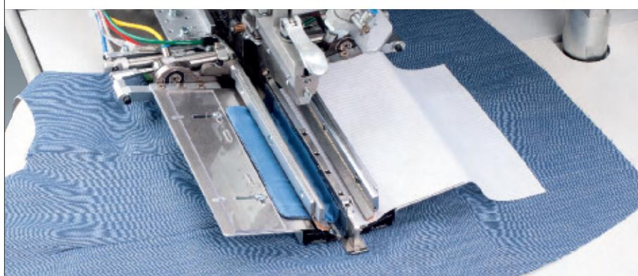
**Futtertaschen** in perfekter Qualität ab 4,8 mm Nadelabstand. Der große Durchgang am Oberteil ermöglicht den schnellen automatischen Rücktransport des Futtervorderteils in den Arbeitsbereich zur weiteren Verarbeitung.
