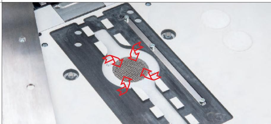
**Ansaugvorrichtung** (Vakuum 0755 590554) zum genauen Positionieren des Nähgutes. Steht keine zentrale Vakuum-Versorgung zur Verfügung ist zusätzlich das Vakuumgebläse (9880 755014) erforderlich.
