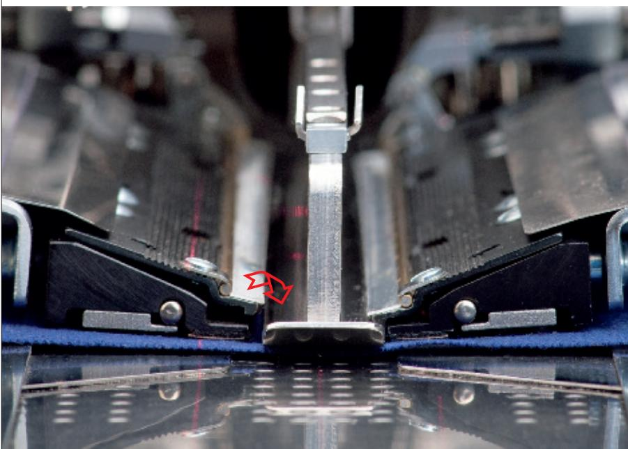
**Das spezielle Faltsystem der Transportklammer** sichert die automatische Anpassung an die Materialstärke.
