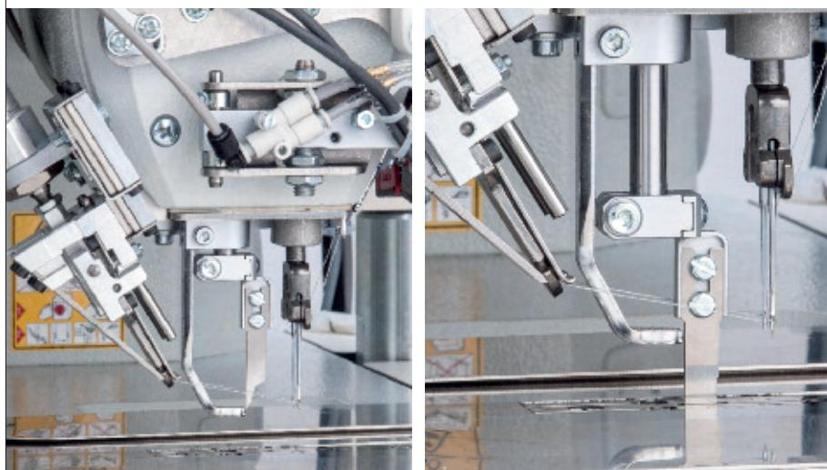
**Schrittmotor gesteuerter Mittelmesserantrieb** mit erweiterter Flexibilität im Materialeinsatz durch erhöhten Materialdurchgang und verstellbarer Hubbühne zur Anpassung an die Materialdicke – reduzierter Messerverschleiß
