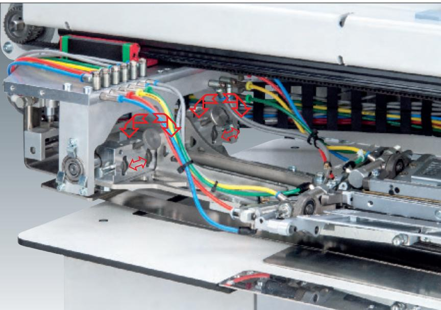
**Manuelle Klammerverstellung**, stufenlos verstellbar (0755 561014), für den manuellen Wechsel von Einfach- auf Doppelpaspel-Anwendungen
