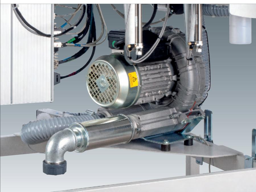
**Das optionale Vakuumgebläse** (Seitenkanalverdichter, 230V, 50/60Hz, Teile-Nr. 9880 755014) ist im Gestell integriert. Es ist erforderlich, wenn keine hauseigene Vakuumversorgung vorhanden ist.
