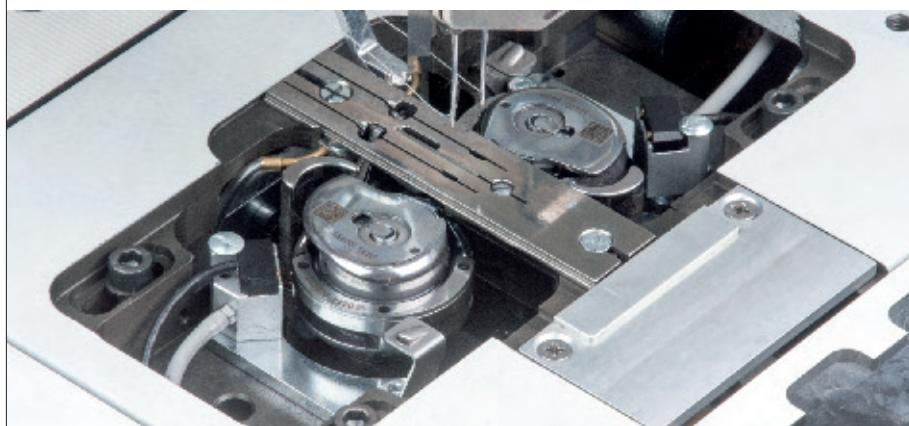
**Großer dreiteiliger Greifer mit Kapselflüfter ( $\varnothing$  26 mm)** ermöglicht einen reduzierten Spulenwechsel durch doppeltes Spulenvolumen. Optional ist ein kleiner Vertikalgreifer (0755 150064 /  $\varnothing$  = 22 mm) erhältlich.
