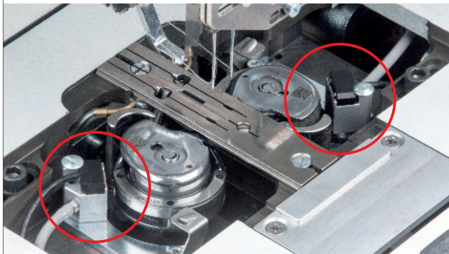
**Der Spulenrestfadenwächter** für die sichere Fertigstellung der Naht ist im Standard der Maschine enthalten.
