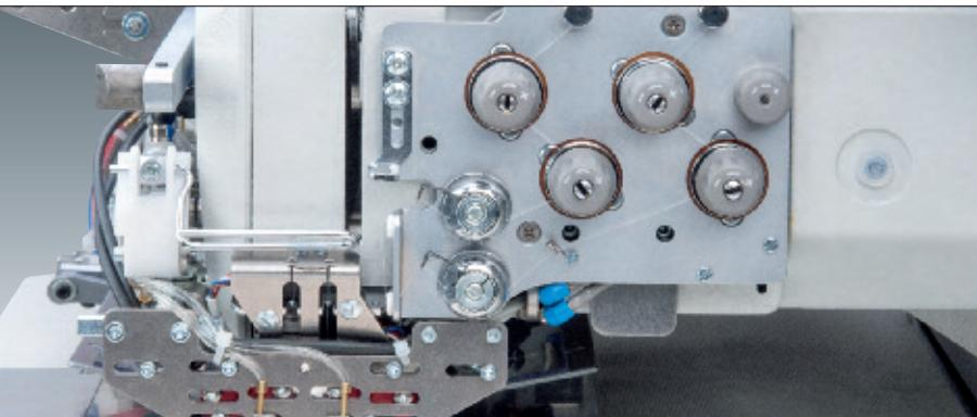
**Die Zusatzfadenspannung** sorgt für eine perfekte Nahtqualität. Der feste Stichanzug im Bereich von Nahtanfang und -ende führt zu einem hochwertigen Nähergebnis.
