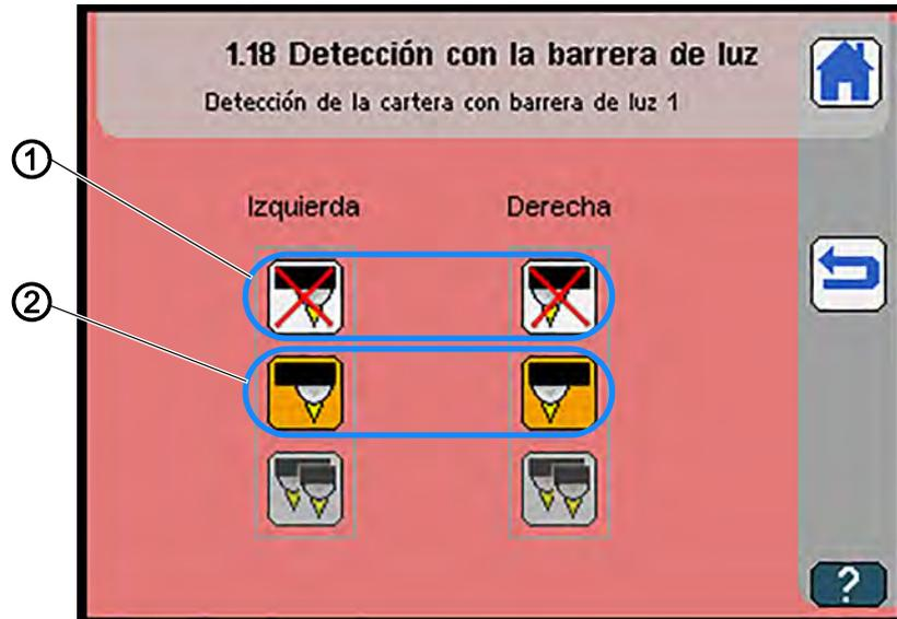
(1) - Detección con la barrera de luz Off    (2) - Escanear la solapa con una fotocélula izquierda/derecha
