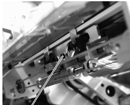
① (1) - Schneideinheit (2) - Anschlag
