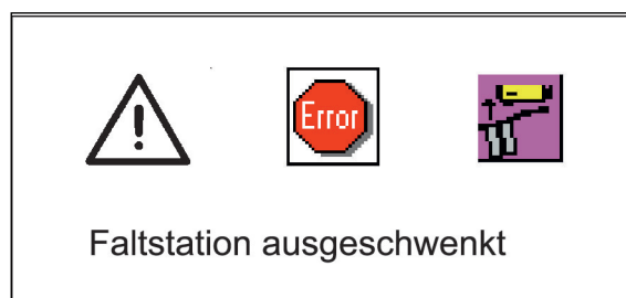
Abb. 3: Meldung "Faltstation ausgeschwenkt"
