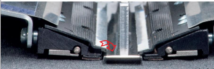
**Das spezielle Faltsystem der Transportklammer** sichert die automatische Anpassung an die Materialstärke.
