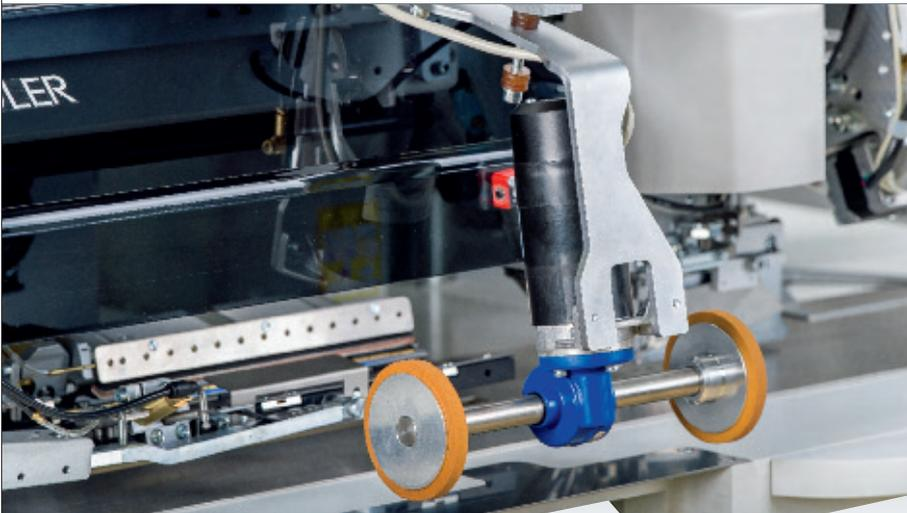
**Die elektronisch regelbare Ausrollvorrichtung** (0745 598394) ist zu verwenden als Abstapelvorrichtung z. B. für Hosenteile in Verbindung mit der Bündelklemme (1970 593194) oder zum Vorrollen von kurzen Teilen in Verbindung mit dem Überwurfstapler (0745 427554).
