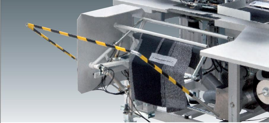
**Überwurfstapler** (0745 427554) zum sauberen Abstapeln von langen Teilen. Der Überwurfstapler senkt sich in der Arbeitshöhe mit wachsender Bündelgröße ab.
