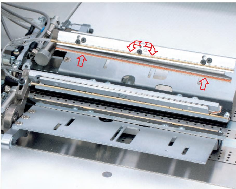
**Die Klammerleisten** sind sowohl flexibel als auch mit Vorspannung einstellbar. Dies unterstützt den Ausgleich von unterschiedlichen Materialstärken. Zudem verteilen die Klammerleisten gleichmäßig Druck auf die Patten. Zum einfacheren Einlegen der Paspel werden die Pattenklammern weiter geöffnet. Die Gummierung an den Pattenklammern verhindert unnötige Abdrücke im Material und gibt besseren Halt.
