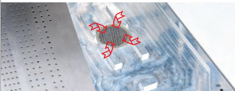
**Ansaugvorrichtung** zum genauen Positionieren des Nähgutes. Steht keine zentrale Vakuum-Versorgung zur Verfügung, ist zusätzlich das Vakuumgebläse (1970 593314) erforderlich.
