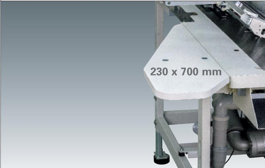
**Die Tischverbreiterung, abgeschrägt** (0745 598274), ermöglicht einen besseren Materialtransfer beim seitlichen Ab stapeln in Verbindung mit dem Zangen- oder Überwurfstapler. Anwendungsempfehlung: Als universelle Tischverbreiterung; für die Verarbeitung von Sakkos/Blazern und Mänteln
