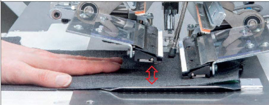
**Zum Ausstreifen des Nähgutes** können die Transportklammern separat voneinander abgesenkt werden (programmierbar). Sie bieten sicheren Halt für das Nähgut beim Materialtransport.
