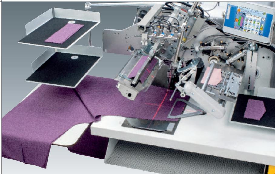
**Ein idealer Einsatz für die 745-35-10 B** ist die Hosenfertigung. Durch die Möglichkeit der exakten Anpassung an die Applikation bietet sie höchste Flexibilität gepaart mit perfekter Produktivität.
