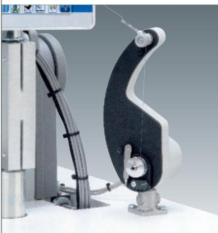
**Separat angetriebener Spuler** für schnelle Farbwechsel
