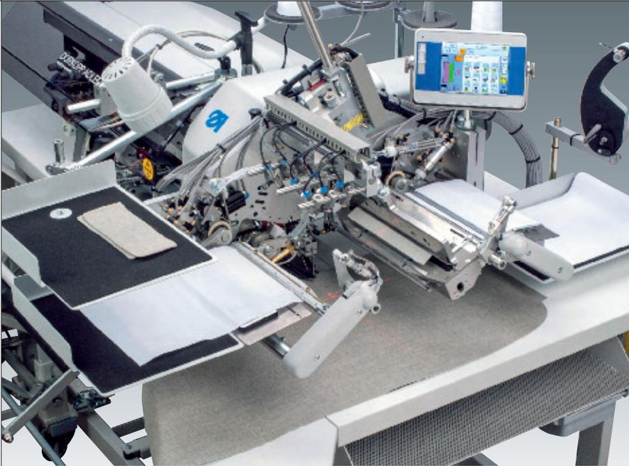
**Bei Sakkoaußentaschen mit gleichzeitigem Annähen von Patte und zwei Taschenbeuteln** bietet die 745-35-10 B eine hervorragende Lösung. Der Teilesatz „Taschenbeutel über Patte“ (0745 598454) erreicht durch eine Durchsichtlichtschranke das Erkennen der Patte durch den darüber liegenden Taschenbeutel.
