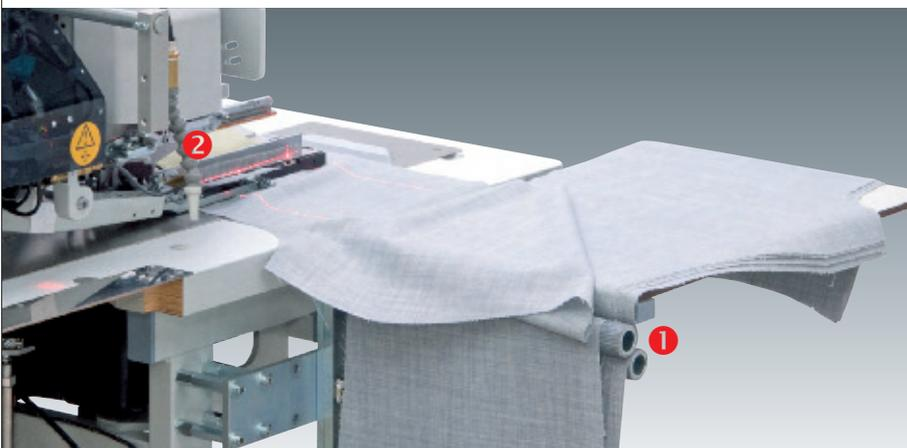
**Die Bündelklemme mit Auflagetisch – nur für 745-35-10 B** (1970 593194) ① ist empfohlen in Verbindung mit der Ausrollvorrichtung (0745 598394) oder mit der Ausblasvorrichtung (0745 598444) ②.
