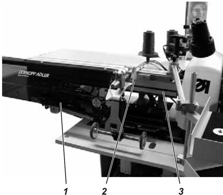
Die Abdeckhaube kann zur besseren Zugänglichkeit der Transportklammern einfach verschoben werden.
