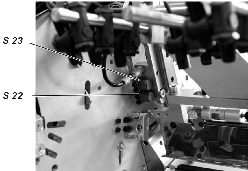
Der eingesetzte faltstempel wird von den Sensoren S 22 und S 23 überwacht. Die Sensoren werden durch eine im Greif-faltstempel hineingedrehte Sechskantschraube betätigt.
