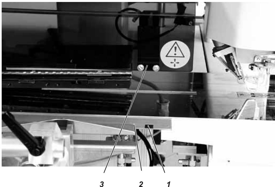
Si l'ouvrage fini n'est pas correctement éjecté, le passage des rayons entre la barrière lumineuse à réflexion (3) et la surface réfléchissante (1) restera interrompu. Impossible donc de commencer une nouvelle couture. L'actionnement de la pédale fait afficher un message d'erreur.
