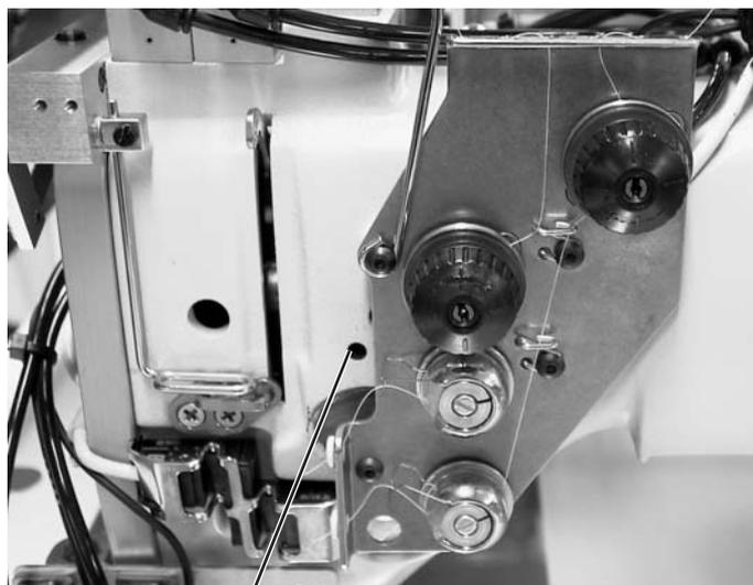
Die Armwellenkurbel 1 ist mit einer Nut 2 (5 mm) versehen.
