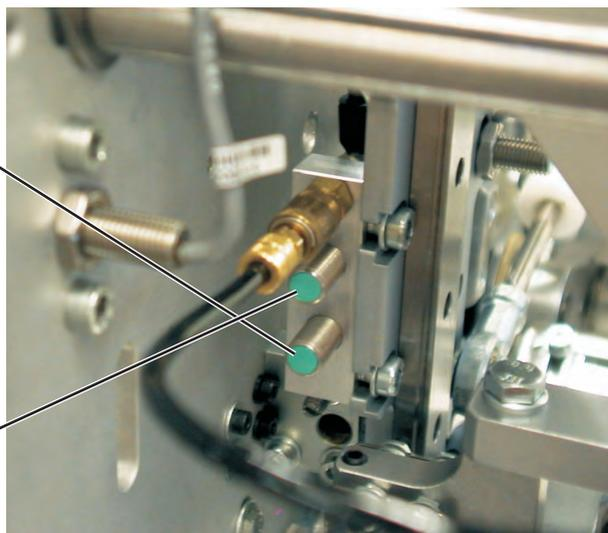
Le tampon de pliage utilisé est surveillé par les capteurs S 7 et S 8. Les capteurs sont actionnés par une équerre de commutation installée sur le tampon de pliage et de serrage.
