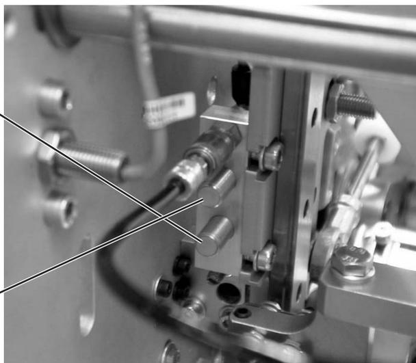
Der eingesetzte Falstempel wird von den Sensoren S 7 und S 8 überwacht. Die Sensoren werden durch einen am Falstempel bzw. Greiffaltstempel befestigten Schaltwinkel betätigt.
