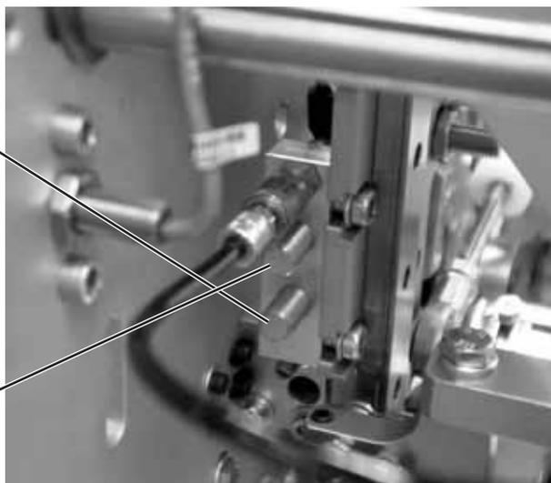
El patín plegador utilizado se controla por los sensores S 7 y S 8. Los sensores se accionan por la pieza de accionamiento montada en el patín plegador o pátin sujetador y plegador.
