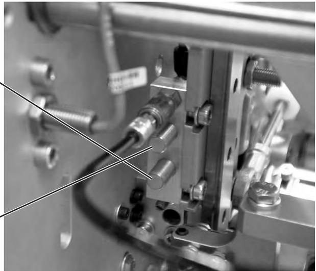
Der eingesetzte Faltstempel wird von den Sensoren S 7 und S 8 überwacht. Die Sensoren werden durch einen am Falt- bzw. Greiffaltstempel befestigten Schaltwinkel betätigt.
