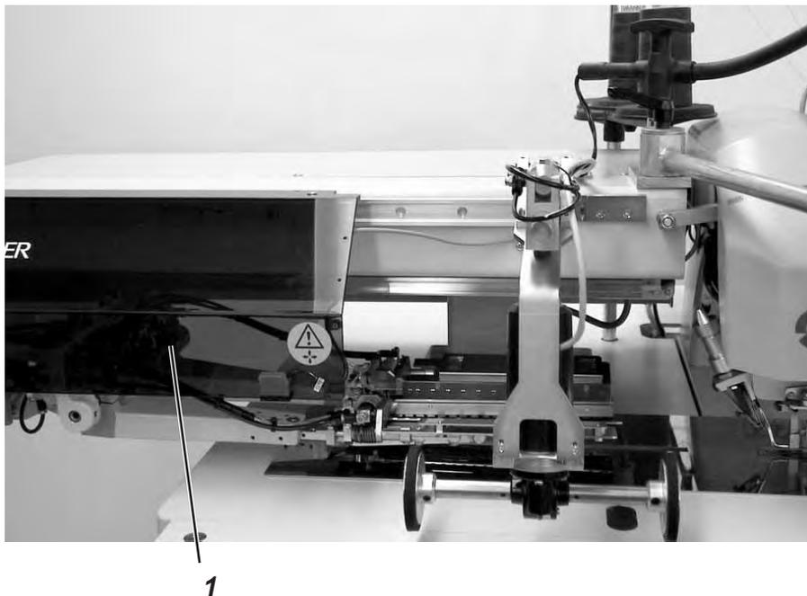
Die Abdeckhaube kann zur besseren Zugänglichkeit der Transportklammern einfach verschoben werden.
