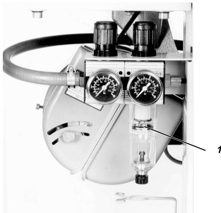
A unidade de manutenção protege a máquina de costura contra partículas de sujidade e água, com vista a evitar entupimentos e formações de ferrugem no sistema pneumático.
