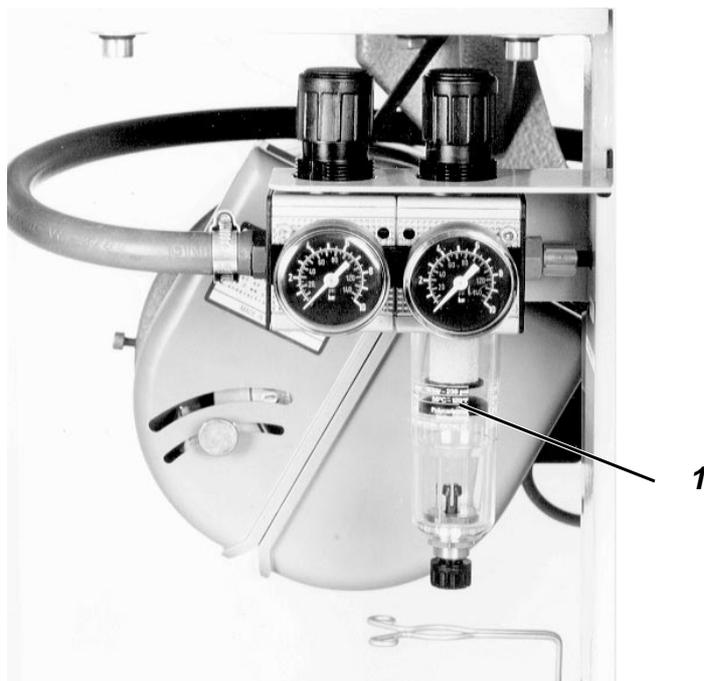
Die Wartungseinheit schützt die Nähanlage vor Schmutzpartikeln und Wasser um Verstopfungen und Rostbildung im pneumatischen System zu verhindern.
