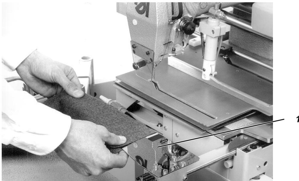
Después de conectar el interruptor principal o de pulsar la tecla "**STOP**", el microordenador verifica la posición inicial de la máquina.
