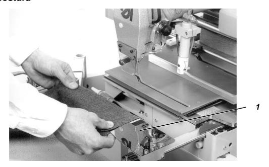
Después de finalizados los trabajos de montaje hay que efectuar un test de costura
