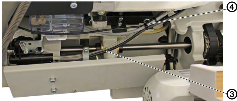
Abb. 11: Kabel des Restfaden-Wächters verlegen II
