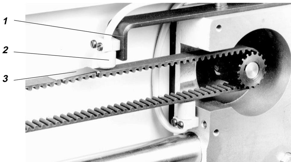
El seguro del exceso de carrera izquierda del carro de transporte se realiza mediante el iniciador b05.
