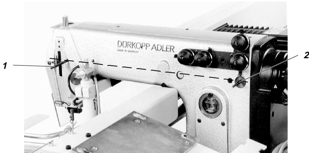
Die Abstecknut der Armwellenkurbel und der Einschnitt **A** des Justierringes müssen auf einer Fluchtlinie liegen.
