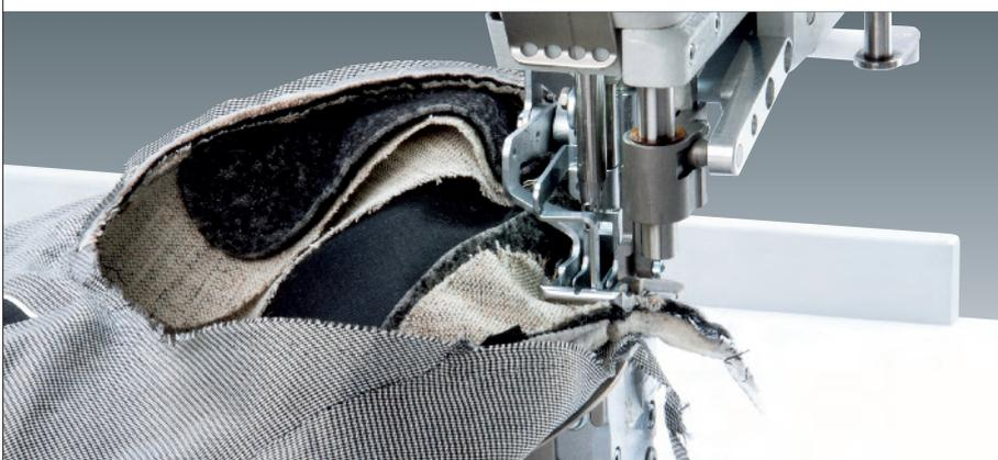
**Die integrierte LED Nähleuchte** ist standardmäßig im Oberteil eingebaut. Sie bietet eine perfekte Ausleuchtung der Nähstelle.
