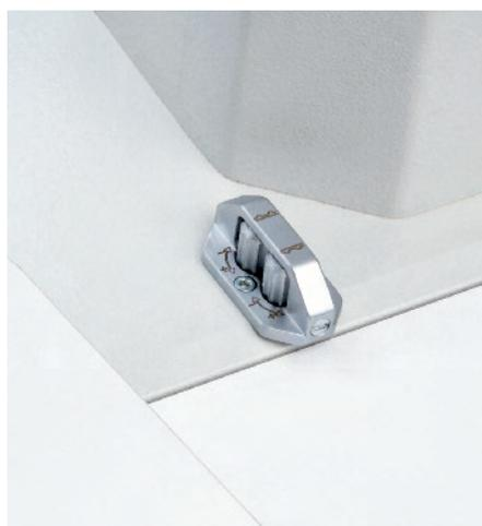
**Der Mehrweitenbetrag** ist mechanisch voreinstellbar und wahlweise in der oberen oder unteren Stofflage – je nach Anwendung – per Knopfdruck abrufbar.
