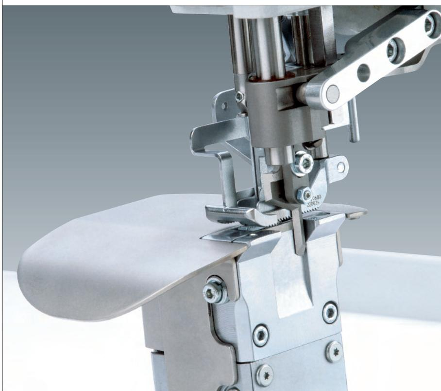
**Der pneumatische Kantenschneider der 680** kann über eine Funktionstaste einfach zu- und abgeschaltet werden. Schnittbreiten von von 6,4 mm, 8 mm und 10 mm sind in Kombination mit Stichtlängen von 6 oder 9 mm realisierbar.
