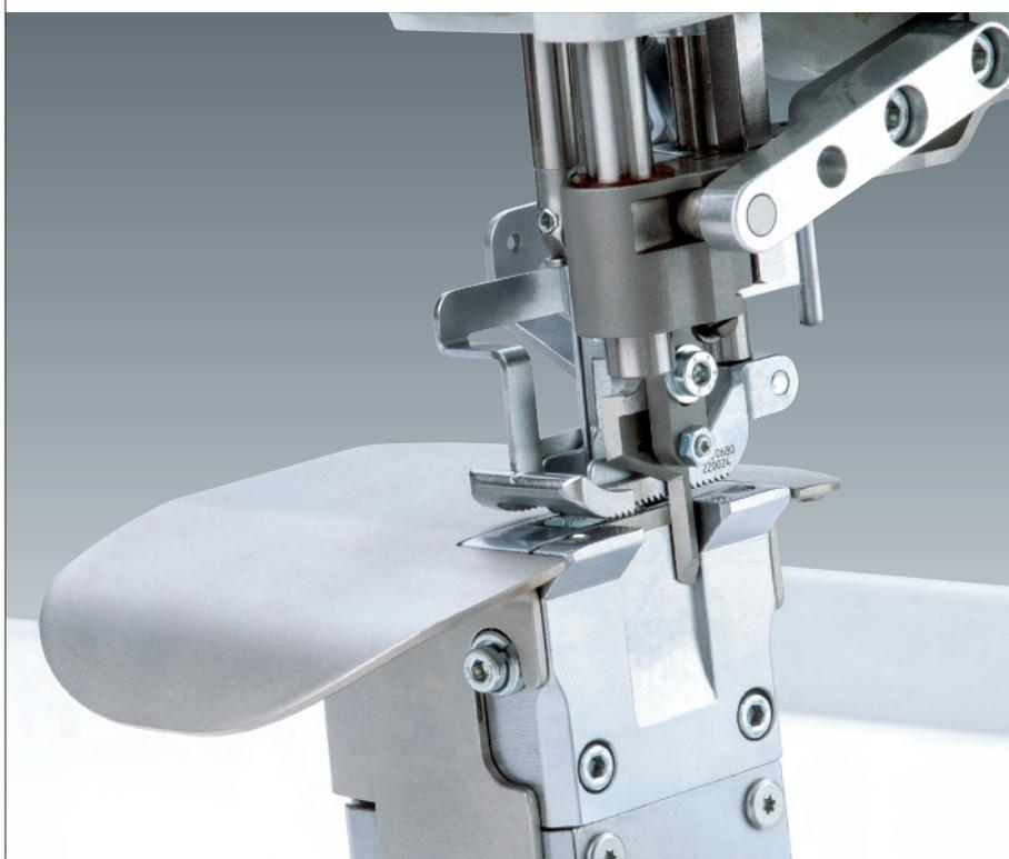
**Der pneumatische Kantenschneider der 680** kann über eine Funktionstaste einfach zu- und abgeschaltet werden. Schnittbreiten von von 6,4 mm, 8 mm und 10 mm sind in Kombination mit Stichtlängen von 6 oder 9 mm realisierbar.
