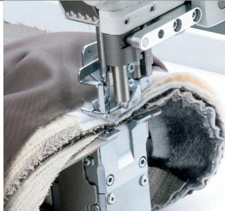
**Die programmierbare, automatische Materialstärken-Erkennung** wird über einen Sensor automatisch zugeschaltet.
