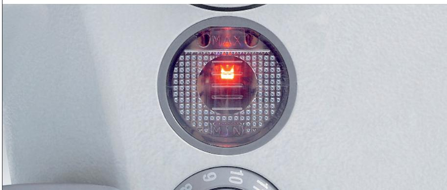
**Die zentrale Öl-Dochtschmierung** ist mit einem Schauglas im Arm positioniert. Optional kann sie mit einer Warnleuchte als Öl-mangelanzeige (9850 867001) ausgestattet werden.
