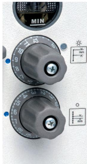
**2. Fadenspannung, 2. Hubhöhe und 2. Stichtlänge** sind manuell oder automatisch zuschaltbar. Ein zuverlässiges Annähen wird bei geringer Fadenspannung durch 2. Fadenspannung in Verbindung mit Stichverdichtung erzielt.
