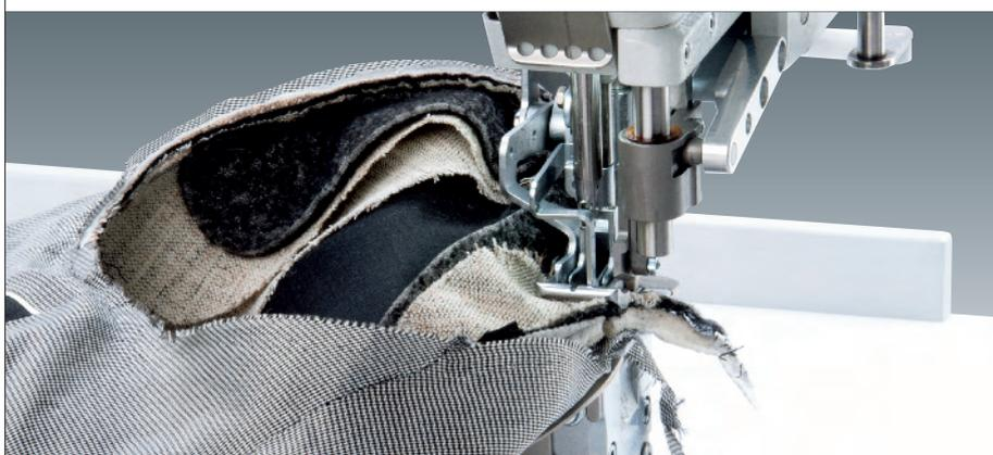
**Die integrierte LED Nähleuchte** ist standardmäßig im Oberenteil eingebaut. Sie bietet eine perfekte Ausleuchtung der Nähstelle.
