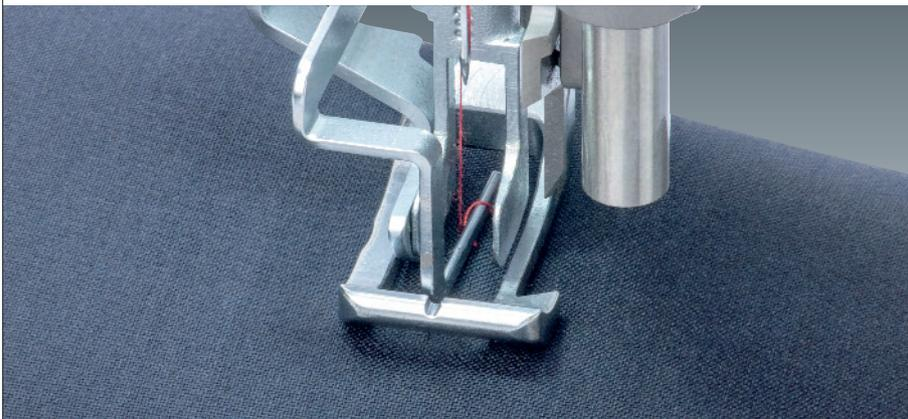
**Die Stichlockerungseinrichtung** verhindert beim Durchnähen des Schulterpolsters ein Zusammenziehen. Somit behält das Polster sein Volumen und seinen weichen Griff.
