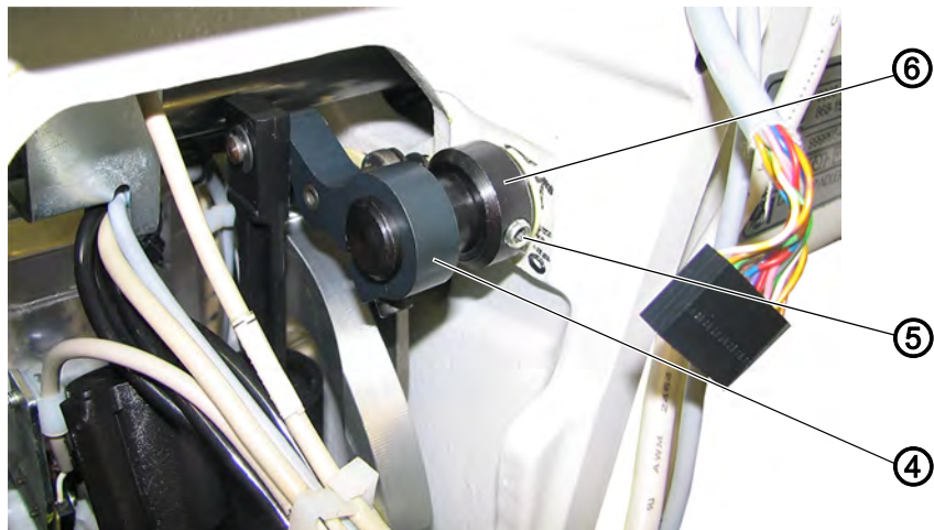
Abb. 50: Mechanische Nähfuß-Lüftung einstellen (2)
