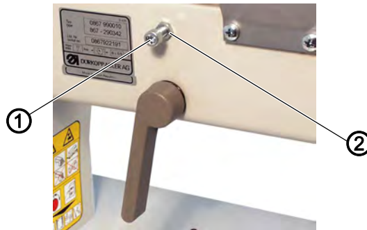
Abb. 52: Höhe der pneumatisch gelüfteten Nähfüße einstellen
