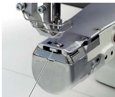
Fig. 22: Regolazione dell'altezza della griffa nel punto morto superiore
