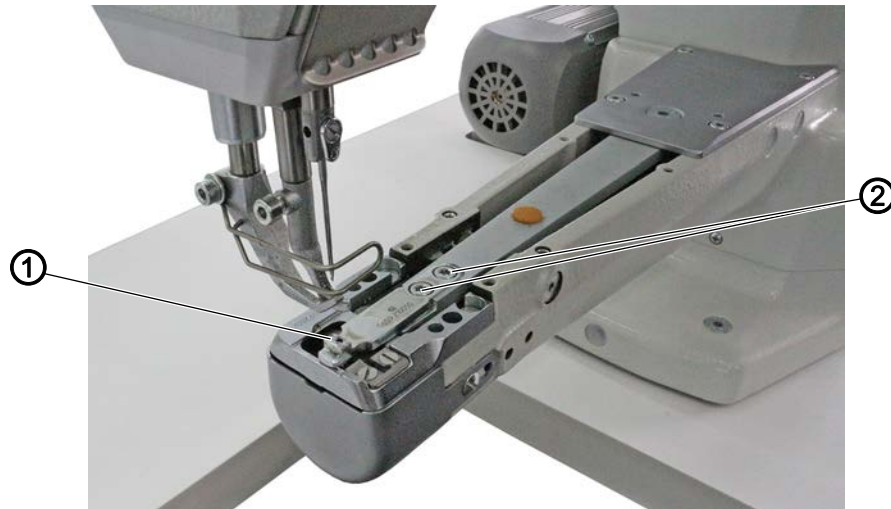
Fig. 10: Smontaggio e montaggio della griffa di trasporto
