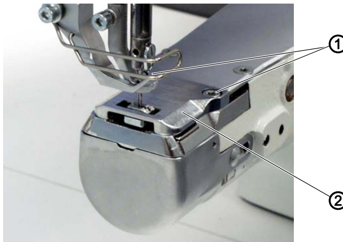
Fig. 9: Smontaggio e montaggio della placca ago
