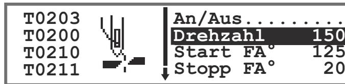
Bei der Aktivierung des *Parameter anz.* erweitern sich die Menüs im Manuellen Modus und im Automatikmodus um den Punkt *Param. aufrufen*. Diese Funktion wird gesondert beschrieben (📖 S. 70).
