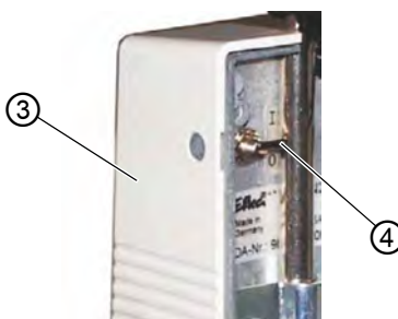
Fig. 17: Ajuste do curso do calcador (2)
