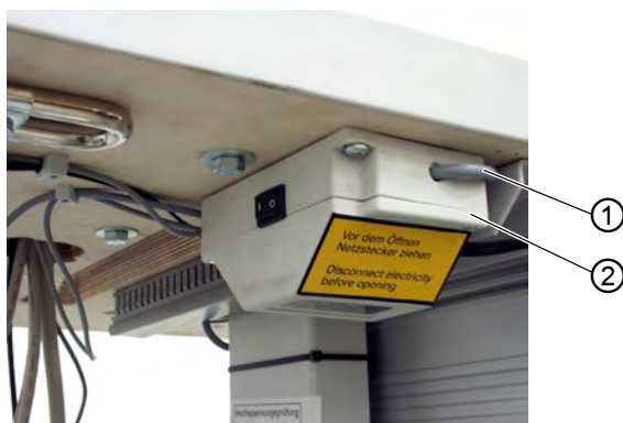
(1) - Cabo de conexão com a rede (2) - Transformador do iluminador
