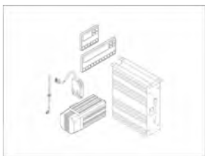
Abb. 24: Nähen mit Maschinen mit Gleichstrom-Positionierantrieb Efka (1)
