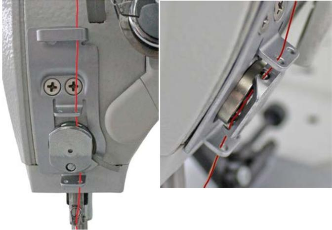
17. Faden von links in die Fadenklemme schieben, so dass der Faden im Haken der Klemme gehalten wird.
