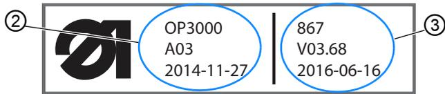
(2) - Software-Version des OP3000 (3) - Software der Steuerung
